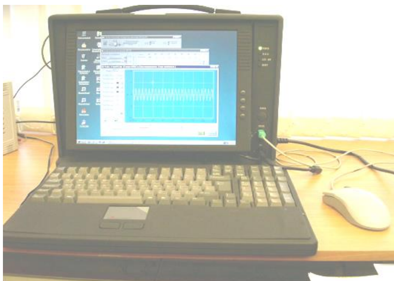
Рис.2..1.1.1.2. Цифровой регистратор сигналов на базе ПК
